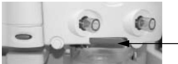
2. Flow-Sensor-Modul aus dem Beatmungssystem herausziehen.
