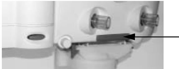
2. Flow-Sensor-Modul aus dem Beatmungssystem ziehen.
