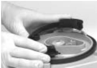
6. Dichtung entfernen.
