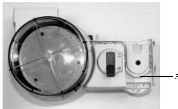
5. Ventileinheiten (1) am Beatmungsmodul einbauen. Ventilabdeckungen (2) in die Laschen (3) der Ventileinheit drücken.
