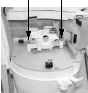
2. Balgeneinheit umdrehen. Formteil positionieren. Sicherstellen, dass es in die korrekten Anschlüsse eingefügt wird, wie abgebildet. Dann auf die Mitte des Formteils drücken (Pfeil), um es an der Basisplatte des Faltenbalgs einrasten zu lassen.
