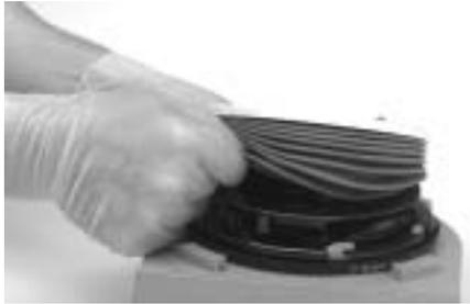
6. Balgenkammer montieren und zur Befestigung im Uhrzeigersinn drehen. Das Gehäuse muss fest sitzen und darf sich nicht mehr anheben lassen.
