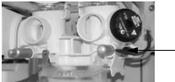
5. Flow-Sensoren aus dem Modul entfernen.
