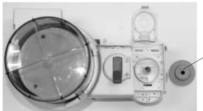
11. Die Balgeneinheit umdrehen und mit drei Fingern in die Öffnungen (Pfeile) des Formteils fassen und gerade wegziehen.
