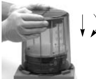
7. Falls bei Durchführung der oben aufgeführten Schritte ein staubähnliches Puder auf der Balgenkammer oder dem Faltenbalg zu sehen ist, sollte eine dünne Schicht KRYTOX-Gleitmittel auf die Falten aufgetragen werden. Das Gleitmittel gleichmäßig und ohne Klumpen auftragen.
