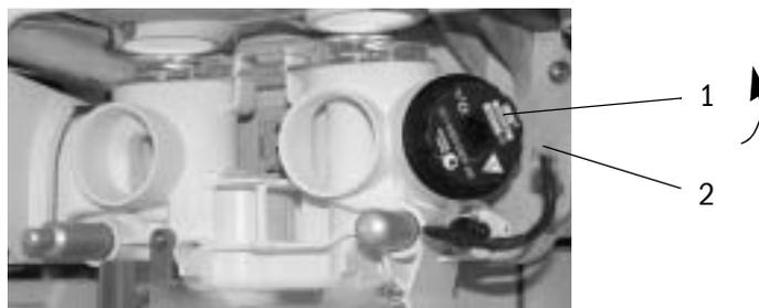
4. Sicherstellen, dass sich der O-Ring (1) auf dem Sensor befindet. Den O<sub>2</sub>-Sensor eindrehen und Kabel wieder anschließen.
