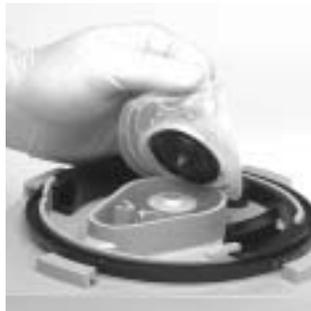
4. Die Sicherungslasche zur Mitte drücken und die untere Basisplatte montieren. Dabei muss ein Doppelklickgeräusch hörbar sein.
