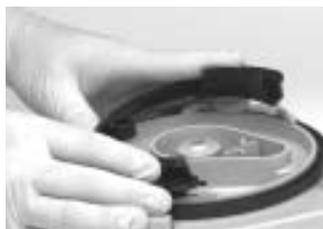
6. Dichtung entfernen.
