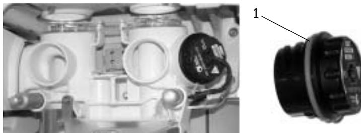
5. Flow-Sensor-Modul wieder am System montieren und die Lasche (1) schließen, um das Modul zu sichern.
