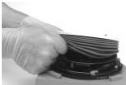
3. Die Sicherungslasche zur Mitte drücken und die Basisplatte entfernen.
