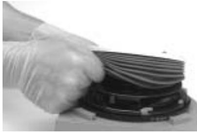
6. Balgenkammer montieren und zur Befestigung im Uhrzeigersinn drehen. Das Gehäuse muss fest sitzen und darf sich nicht mehr anheben lassen.
